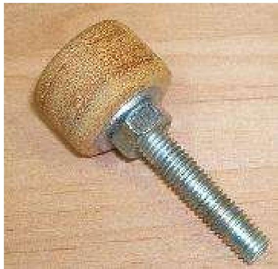
Bei meiner Staffelei sind an den Spreitzbegrenzern und zur Verstellung des Bildträgers selbstgedrechselte Holzknöpfe zum Einsatz gekommen. Die müssen aus Hartholz sein, und eine entsprechende Bohrung für ein 8er Gewinde haben.
