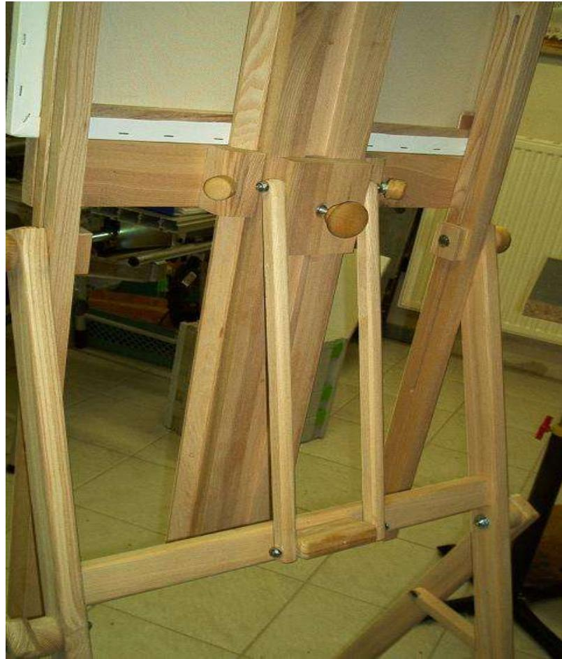
Die untere Leinwandauflage besteht aus einem Brett  $55 \times 8$  cm, welches mit Holzschrauben an die beiden Führungen geschraubt wird. Die machen wir jetzt.
